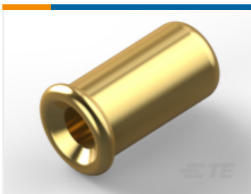
TE 产品编号 CAT-377-MSSOB4 微型弹簧插座：底部开口，镀铜，6.5A
