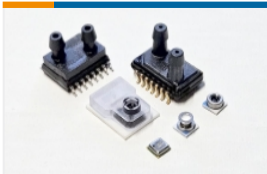
板安装压力传感器(69)
