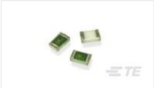
TE 产品编号1676218-2 RN 0805 1K02 0.1% 10PPM 1KRL
