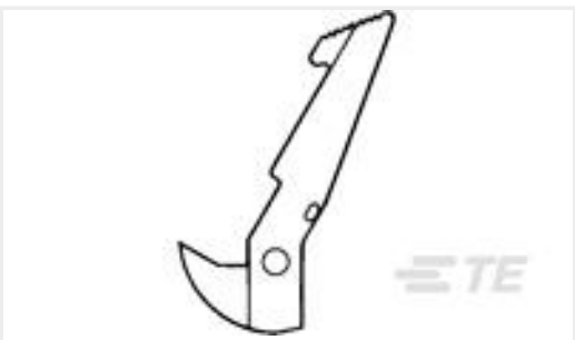
TE 产品编号111293-1 UNIVERSAL HEADER LATCH
