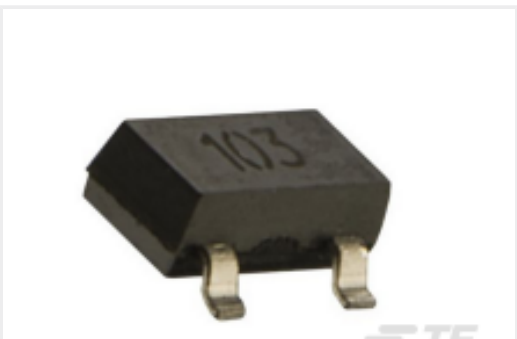
TE 产品编号G-NICO-001 NI 1000 DIN 43760 KL.B SOT23
