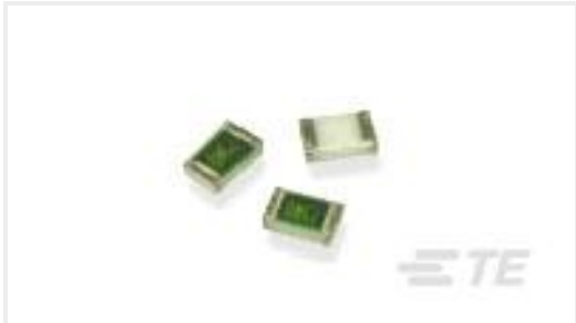
TE 产品编号3-1625867-3 RP 1J 0.166W 13R3 0.1% 25PPM 1K RL
