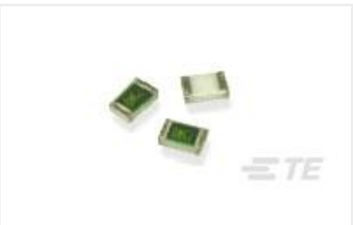
TE 产品编号6-1879134-7 RN 0603 48K7 0.1% 10PPM 1K RL
