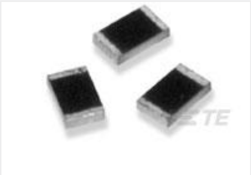
TE 产品编号1625867-5 RP 1J 0.166W 2K21 0.1% 25PPM 1K RL
