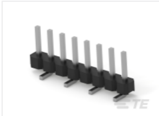
TE 产品编号2842104-8 8P,2MM,BRK HDR,SRVT,SMD,0.76AU, TR W/CAP
