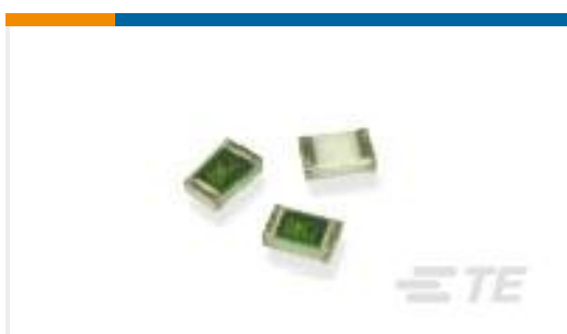
TE 产品编号 6-2176092-1 RP 2A 0.25W 3K24 0.1% 25PPM 1K RL
