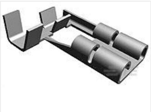
TE 产品编号100645-3 250 FASTON,FLAG,REC.,14-17AWG, PHBRZ
