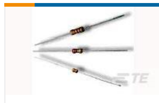
TE 产品编号1623930-3 CFR25 5% 10K
