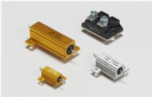
机箱安装电阻器(667)
