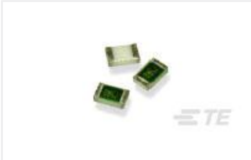
TE 产品编号 9-1879222-4 CPF 0603 205R 0.1% 25PPM 1K RL
