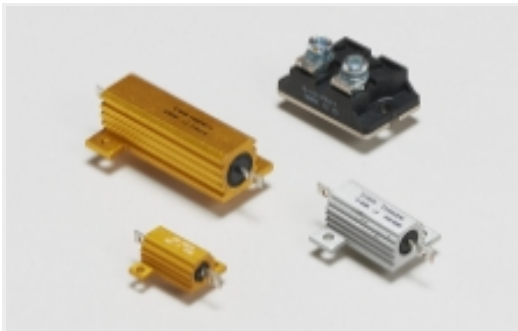
机箱安装电阻器(241)
