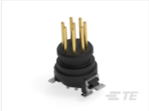
TE 产品编号515632-E M12 MALE, UNI CODE, 8P, 10.5MM SMT, DI
