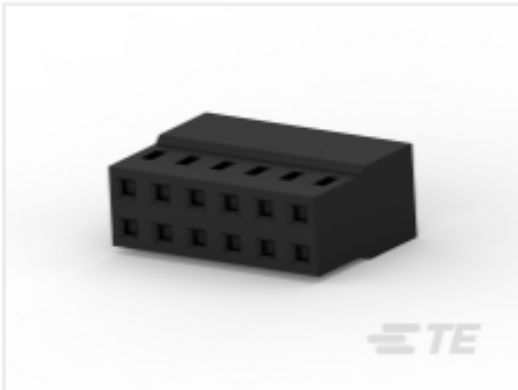
TE 产品编号 1-2316108-2 12P,2MM,REC,HSG,DR,CRIMP,PLAIN, BOX
