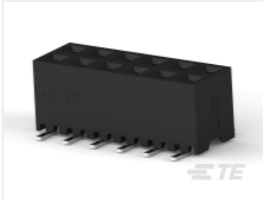
TE 产品编号 1-2314845-2 12P,2MM,BB,REC,DRV,T,SMD,AU.38, TB,W/CP
