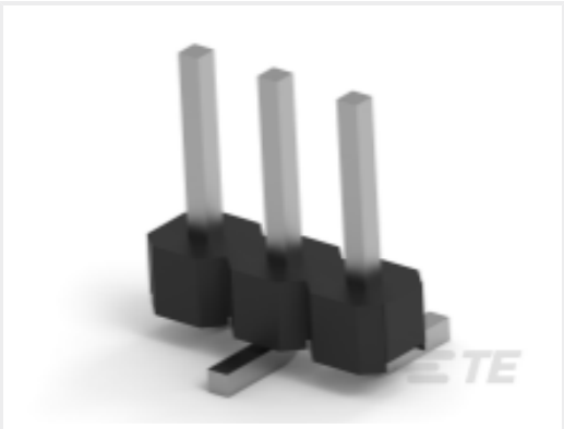
TE 产品编号2842104-3 3P,2MM,BRK HDR,SRVT,SMD,0.76AU, TR W/CAP
