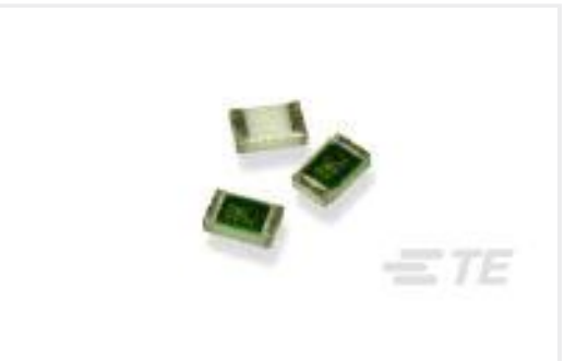
TE 产品编号1879225-7 CPF 0603 44K2 0.1% 25PPM 1K RL
