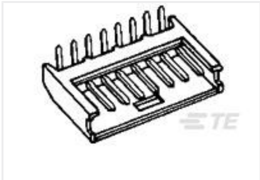
TE 产品编号280381-2 10P MODU II SHRD HDR, RT ANG, 0.38 AU
