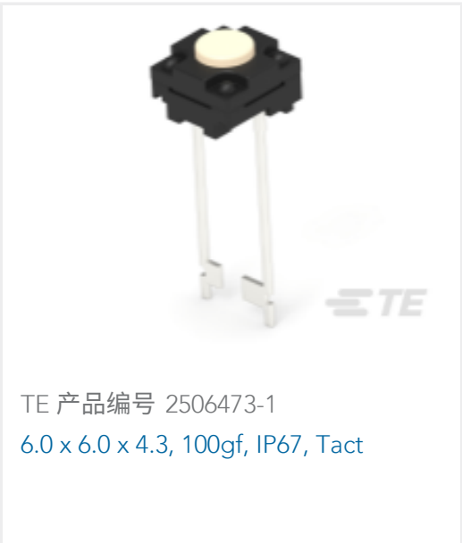
TE 产品编号 2506473-1 6.0 x 6.0 x 4.3, 100gf, IP67, Tact
