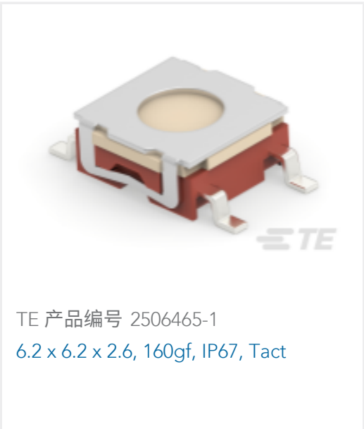
TE 产品编号 2506465-1 6.2 x 6.2 x 2.6, 160gf, IP67, Tact
