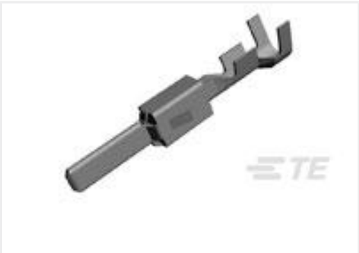
TE 产品编号1-962915-2 TAB 2.8x0.8 CONTACT CS SWS Ag
