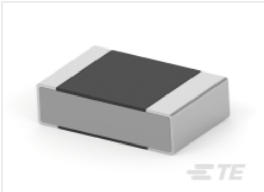
TE 产品编号4-2176271-4 RU 0805 750R 0.01% 2PPM 1K RL
