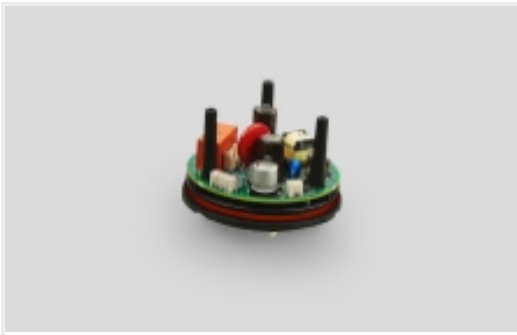
街道照明电源管理(6)
