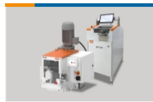
高压线束加工设备(7)
