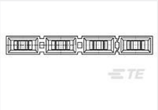
TE 产品编号 826853-3 3P,AMPMODU I SHUNT,GREEN
