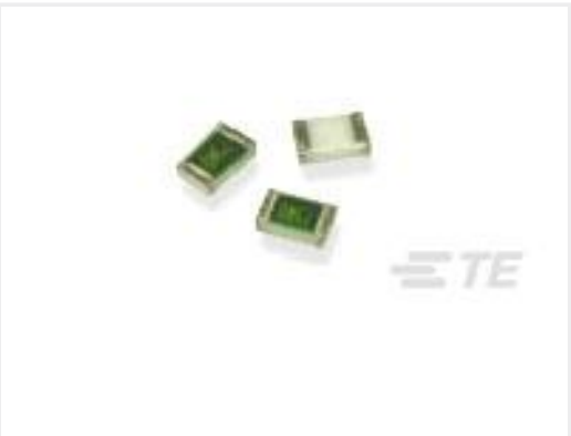
TE 产品编号1676277-2 RN 0805 28K7 0.1% 10PPM 1KRL
