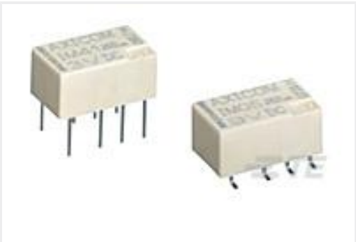
TE 产品编号5-1462037-5 IM41JR=IM RELAY 100mW 3V BIS
