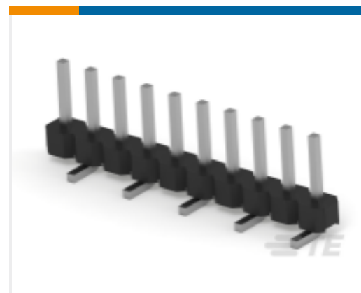
TE 产品编号1-2842102-0 10P,2MM,BRK HDR,SRVT,SMD,0.1AU, TR W/CAP
