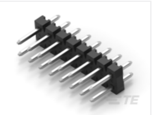
TE 产品编号 1-2842138-0 20P,2MM,BRK HDR,DRV,T,2.8,0.1AU,BOX
