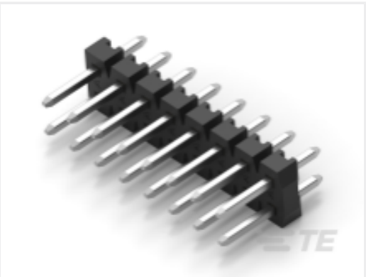
TE 产品编号 1-2842130-0 20P,2MM,BRK HDR,DRV,2.8,0.1AU, TB W/CAP
