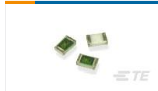
TE 产品编号1676650-2 RN 0805 14R3 0.1% 10PPM 1K RL
