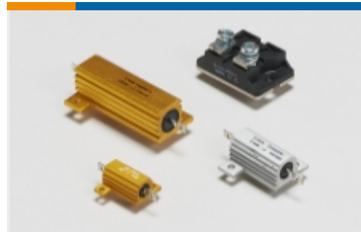
机箱安装电阻器(1068)
