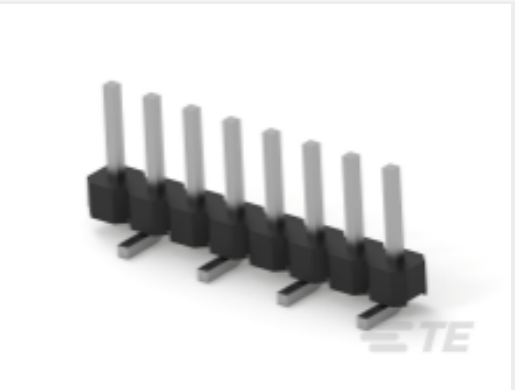
TE 产品编号2842104-8 8P,2MM,BRK HDR,SRVT,SMD,0.76AU, TR W/CAP
