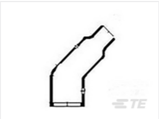
TE 产品编号CAT-R21-73105422 热缩护套：聚合物成型，有嘴
