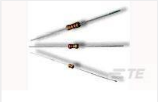
TE 产品编号4-1623925-8 CFR100 5% 68K
