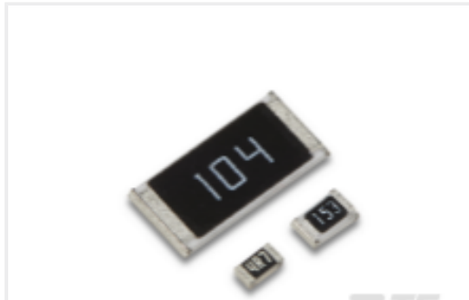
TE 产品编号2-2176339-0 CRGCQ 0603 390R 1%
