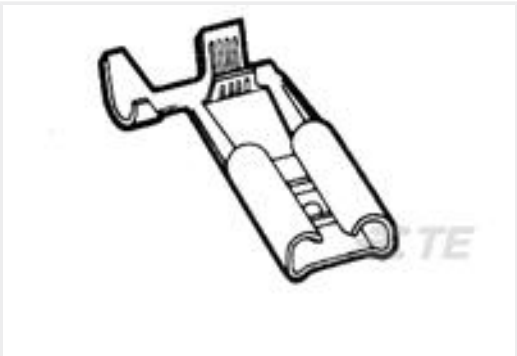
TE 产品编号180464-2 250 FASTON,FLAG,REC.,14-17AWG, LATON
