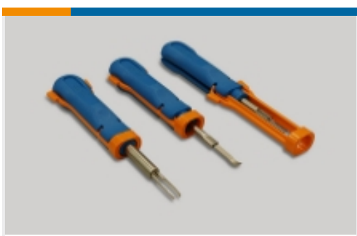
插入和拔出工具(1)
