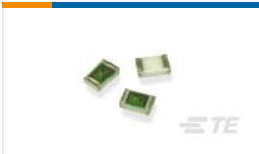
TE 产品编号1676324-2 RN 0805 3K16 0.1% 10PPM 1KRL
