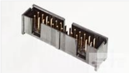
TE 产品编号3-1761603-7 IDC LOW PRO HDR 64P VERT BLUE
