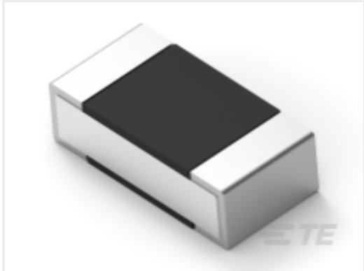
TE 产品编号2176307-4 RP 1E 0.1W 13K3 0.1% 25PPM 5K RL
