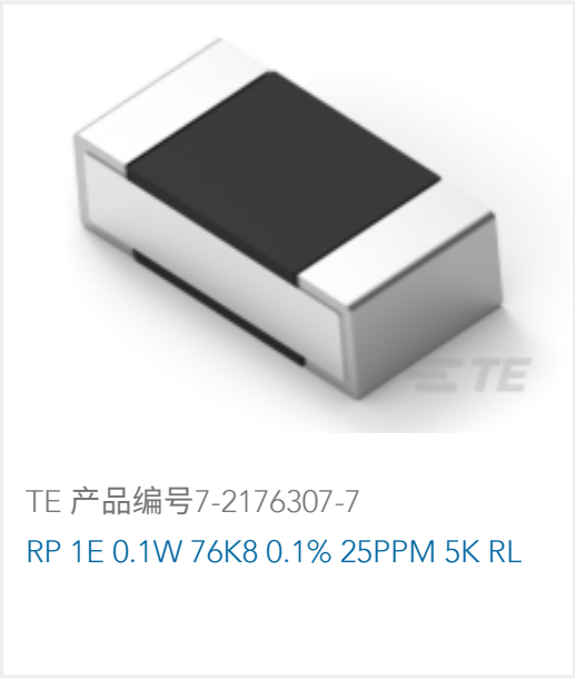
TE 产品编号7-2176307-7 RP 1E 0.1W 76K8 0.1% 25PPM 5K RL
