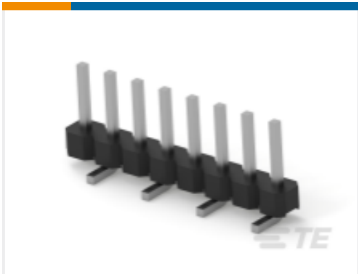
TE 产品编号2842104-8 8P,2MM,BRK HDR,SRVT,SMD,0.76AU, TR W/CAP
