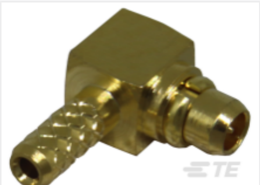
TE 产品编号CONMMCX012-R178 MMCX Jack 50 Ohm Cable Crimp
