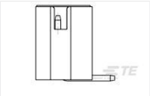
TE 产品编号1775470-3 HPI CONN., 2.0MM, V/T, SMT, 3P, 80U"
