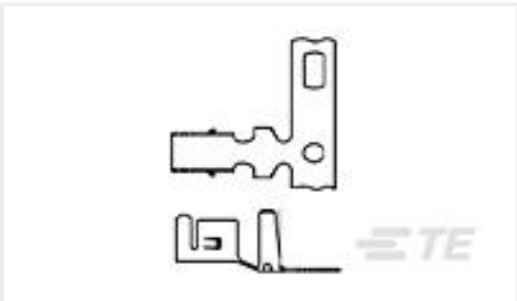
TE 产品编号3-794013-1 MINI AMP-IN 12 AWG WIRE
