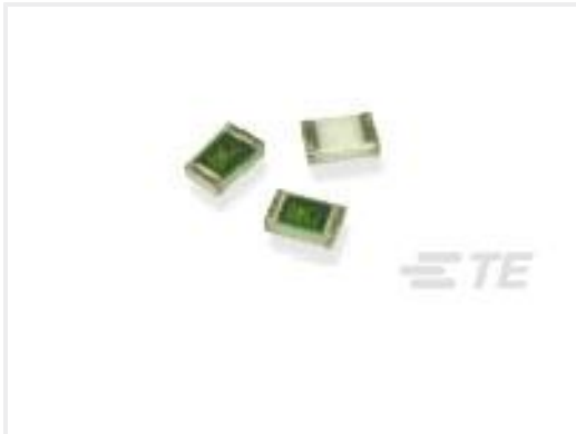
TE 产品编号1-1614351-9 RN 0603 1K0 0.1% 10PPM CUT LEN
